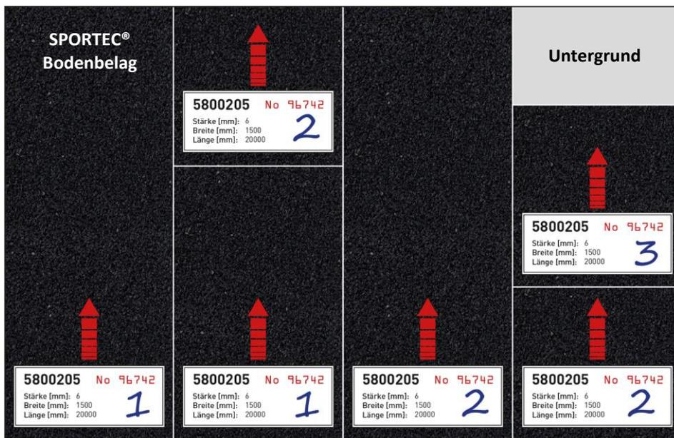
Ausrollen der fortlaufenden Bahnen in die gleiche Laufrichtung
